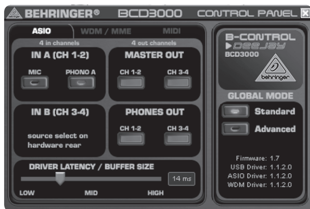
Abb. 4.2: Das ASIO-Fenster des BCD3000 Control Panels
