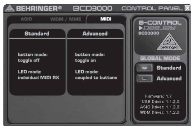
Abb. 4.4: Das MIDI-Fenster des BCD3000-Control Panels
