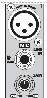
Afb. 2.1: Aansluitingen en regelknoppen van de Mic-/Line-ingangen
