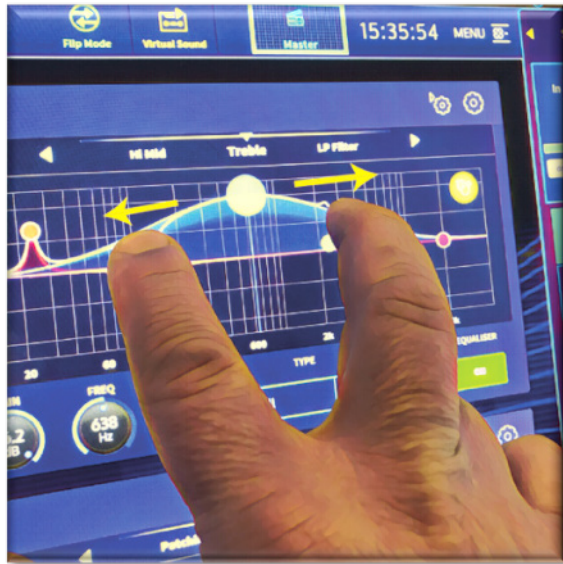
Pinch-Geste zur Einstellung der EQ-Bandbreite
